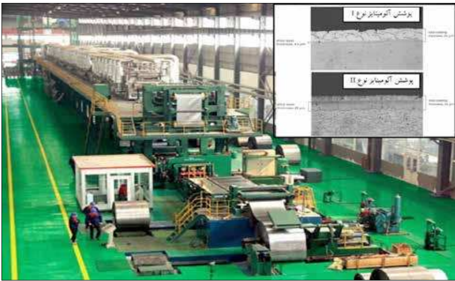
شکل ۱- خط تولید اکسیداسیون ورق فولادی و انواع ورق های فولادی آلومینایز شده.
