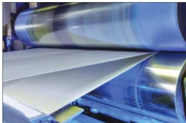
شکل ۲- فرایند تولید فولاد بوندال در شرکت تیسن کروب
