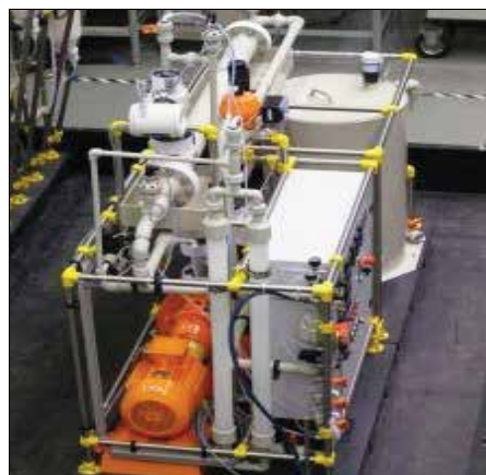
سیستم آزمایشی BFI برای جداسازی جامدات از اسیدها
