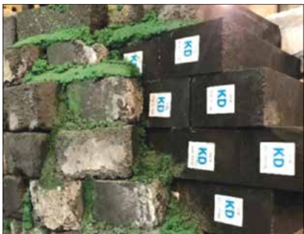
شکل ۴- نسوزهای منیزیم-کربن ساخته شده از بازیافت نسوزهای کوره EAF در فولادسازی سیدنور.
