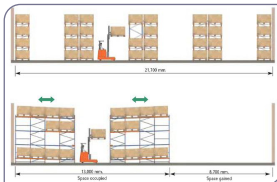
شکل ۴-۹. مقایسه فضا در انبارداری با قفسه رایج و قفسه‌بندی از نوع Push Back
