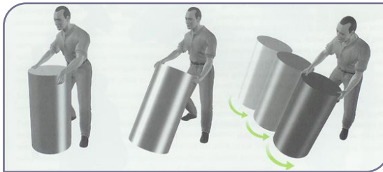
شکل ۱۸-۶. روش بلندکردن بار برای بارهای بشکه‌ای
