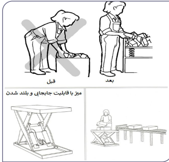
شکل ۱۲-۶. اصلاح ایستگاه کاری
