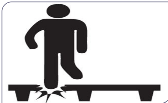
شکل ۱۵-۵. فشار نقطه‌ای روی پالت
