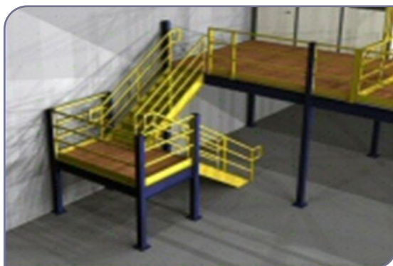
شکل ۲۵-۵. ایجاد پله U شکل
