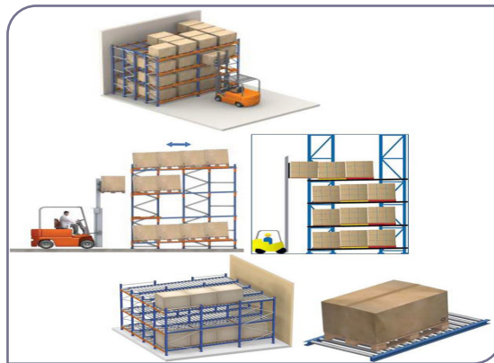
شکل ۴-۸. سیستم قفسه پالتی از نوع Push Back
